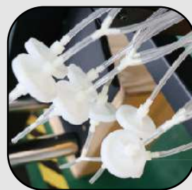
El conjunto de limpieza automática agrega una válvula unidireccional para aumentar la estabilidad del suministro de tinta.
