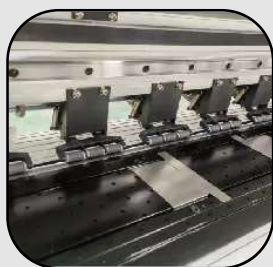
La nueva estructura de rodillos de arrastre en grupo de tres mejora la alimentación.
