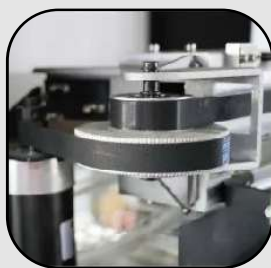
Sistema de poleas tensoras de alta precisión y gran estabilidad.
