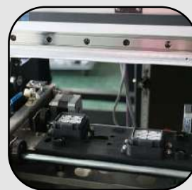
El conjunto de limpieza humectante automático garantiza la estabilidad de la limpieza del cabezal.
